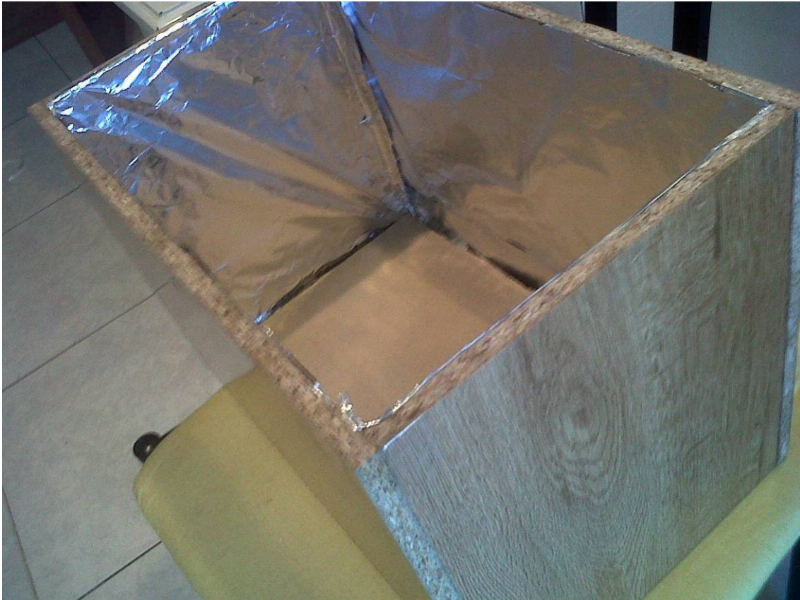
Jaula de Faraday (caja de madera forrada con aluminio)
