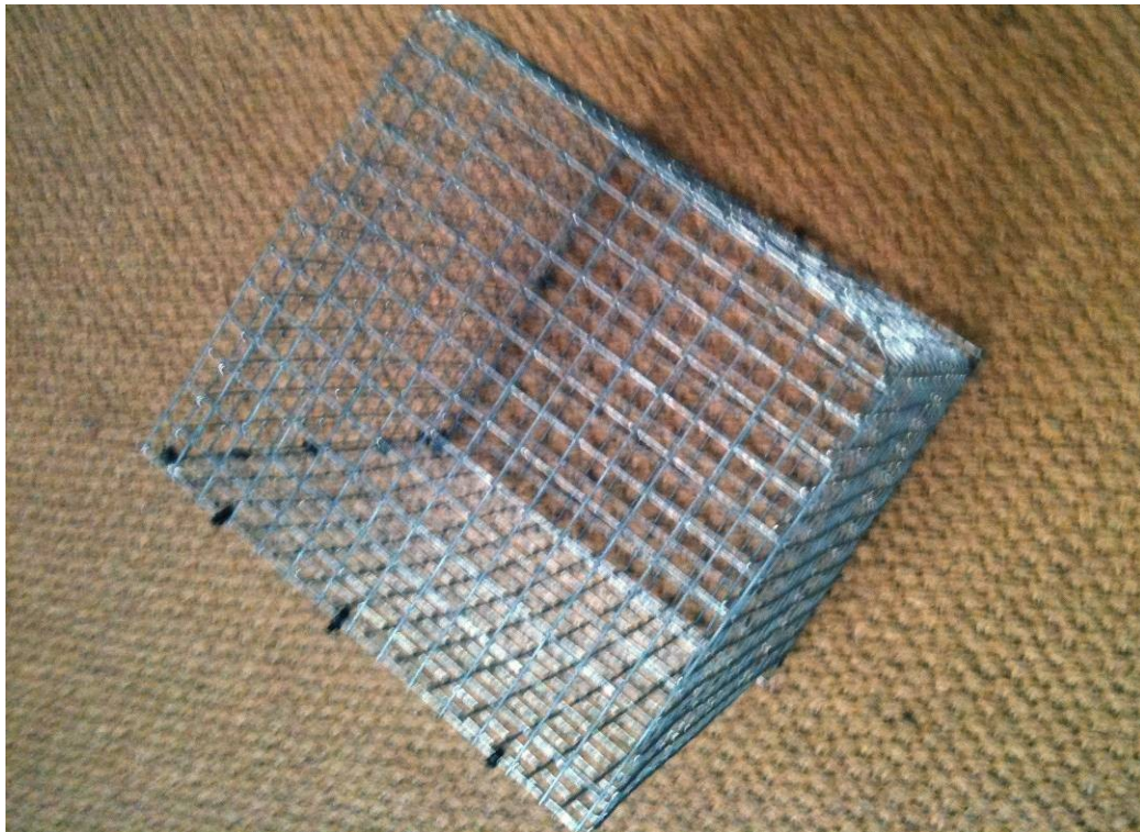
Jaula de Faraday (jaula con tela metálica)
