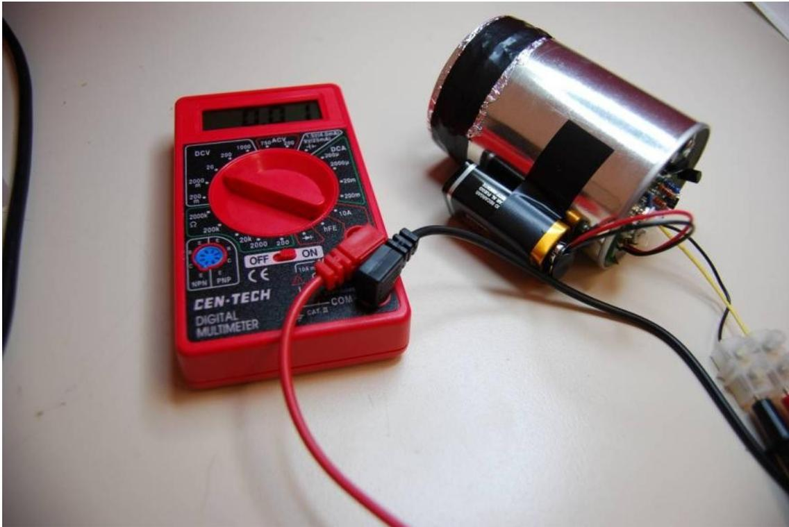
Cámara de iones conectada al galvanómetro.
